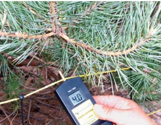
Abb. 42: Spannungsabfall durch Bewuchs
